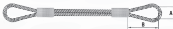
Brache ad anello con due legature Steel wire rope grommets with soft eye
