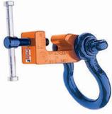
Il morsetto per costruzioni navali **IPBTO10** viene utilizzato come occhiello per paranco temporaneo in spazi che sono stati rinforzati con HP (lampadina) profili come sale macchine e sezioni di navi. Questo morsetto è dotato di un mandrino avvitato per un facile fissaggio del morsetto. Nel momento in cui viene applicato un carico, il morsetto si fissa automaticamente.
